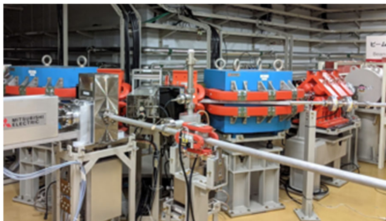
SPring-8旧入射器ライナックの磁石を借用 (QT1, BM1, BM2, Q1, Q2)
