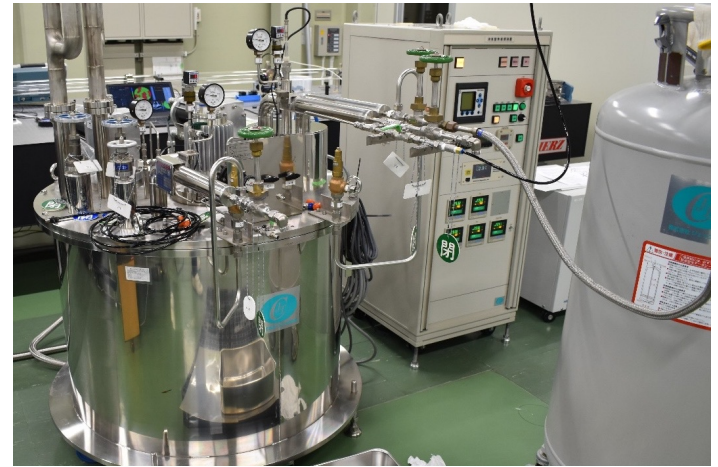
液体窒素循環装置 (~78 K, 6-9 l/min, 0.1 MPa)
